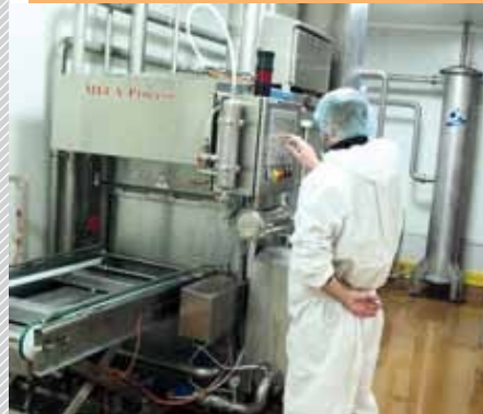
L'opérateur choisit le programme de traitement du tunnel (concentration d'ozone, temps de traitement, immersion ou aspersion) selon les produits à décontaminer.
